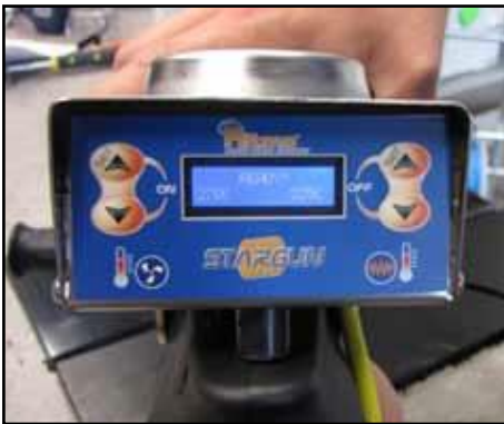
Kontroller temperaturen på både luft og plast
